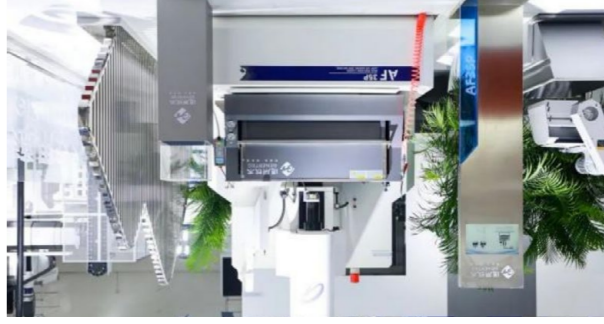
2023 年 4 月，集团参加第十八届中国国际机床展览会。图为通用技术机床研究院的 AF35P 高精度电火花成型机
